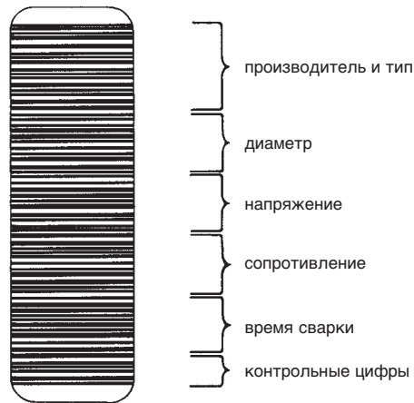
Схематическая структура штрих-кода (2/5 interleaved)
